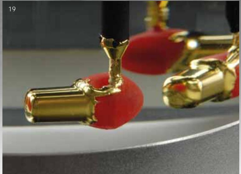
Abb. 18 und 19 Die Feingold-Matrizen wurden vollautomatisch und direkt auf die vorbereitete Oberfläche der Zirkonoxid-Primärteile galvanisiert
